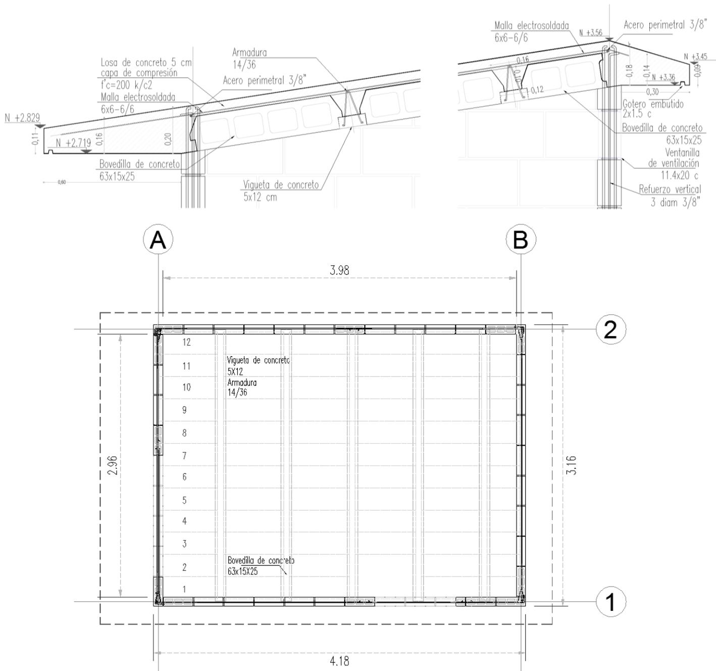
Medición: La losa inclinada de 20 cm de espesor hecha a base de vigueta y bovedilla por unidad de precio unitario y tiempo determinado sean ejecutados a satisfacción a través de la de supervisión, se medirán para determinar el avance o la cantidad de trabajo realizado para efecto de pago, como sigue:
