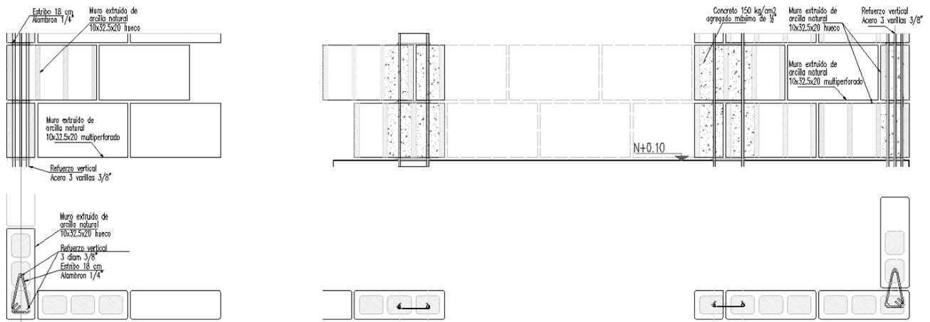
Medición: El muro de block extruido de arcilla natural 10x32.5x20 cm por unidad de precio unitario y tiempo determinado sean ejecutados a satisfacción a través de la supervisión y control de obra, se medirán, para determinar el avance o la cantidad de trabajo realizado para efecto de pago, como sigue:
